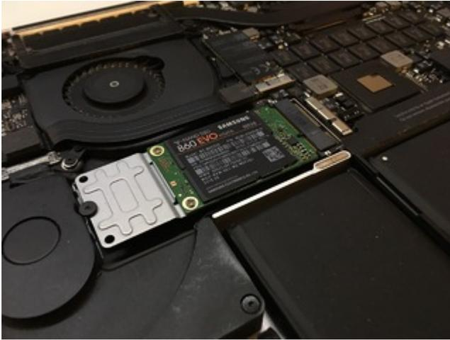
Anmerkung: Die im Bild dargestellte und anfänglich verbaute Samsung SSD führte nach einer Weile zu erheblichen Problemen, die vermutlich auf die Inkompatibilitäten bzgl. Trim zurückzuführen sind. Heute werkelt eine Kingston mSATA SSD mit 1TB in dem aufgerüsteten Gerät.
