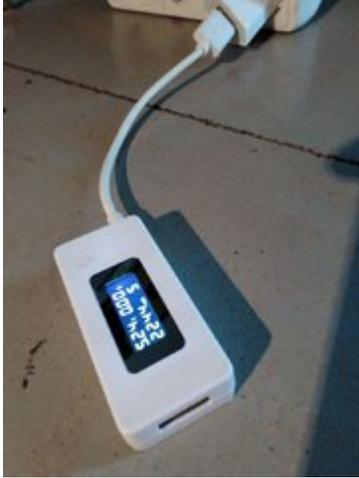
aber superpraktisch - auch die mAh anzeige. hat 10 "speicherplätze" für sowas. diese kabel und netzteile kann man so bestens aussortieren.
