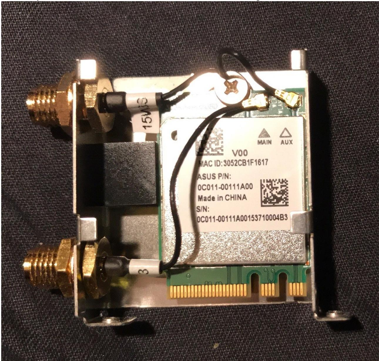
Der Plan wäre jetzt, die Karte durch eine mit BCM94352Z, also zum Beispiel Dell DW1560, zu ersetzen. Ist das sinnvoll?
