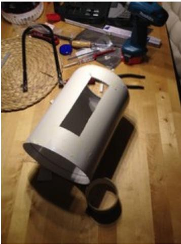
Zuerste wurden das Bodenelement für den Gehäuse Lüfter passend gemacht, danach wurde die Öffnung in den ehemaligen Mülleimerboden gesägt. Die Aussparung für die ATX Blende wurde gesägt.
