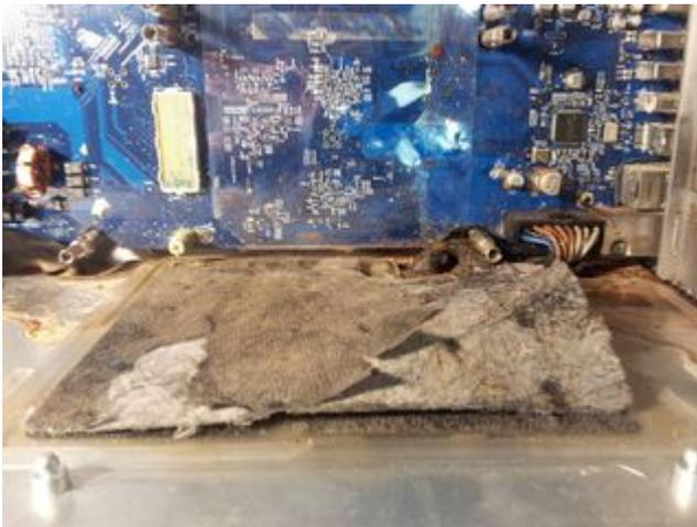
Die rechte Ecke des MB (Modem/LAN) macht mir etwas Sorgen - ich hoffe, dass keine Bauteile (SMD etc.) durch die Suppe weggerottet sind. Ähnliches gilt für die untere CPU inkl. Sockel - da ist Grünspan an den Sockelkontakten. Zahnbürste und Isoprop warten schon. 😊
