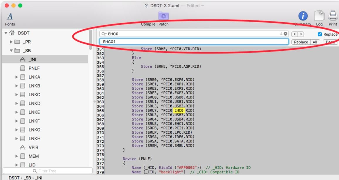
Den Vorgang wiederholen wir analog auch mit EHC1 sprich aus EHC1 wird EHC02. Ist das erledigt kann die DSDT kompiliert und abgespeichert werden. Der erste Schritt ist hiermit getan und es geht weiter mit den [Installationsvorbereitungen](#).
