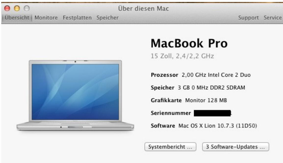
Die Grafikkarte eine Mobile Radeon X1400 wird auch unterstützt nachdem ich in die Info.plist des ATIRadeonX1000.kext die ID der Karte unter <key>IOPCIMatch</key> eingetragen habe.
