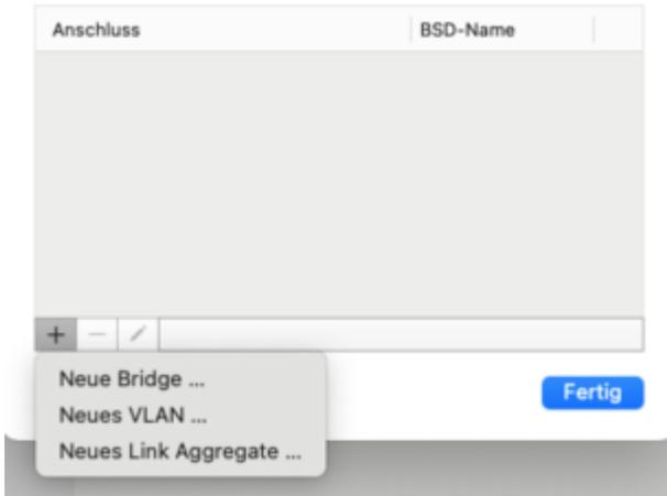
Link Aggregation bezeichnet im Rahmen der Netzwerktechnik verschiedene Verfahren zur Bündelung mehrerer physischer LAN-Schnittstellen zu einem logischen Kanal zum Zwecke der Erhöhung des Datendurchsatzes und der Ausfallsicherheit gegenüber einer einfachen Netzwerkschnittstelle.
