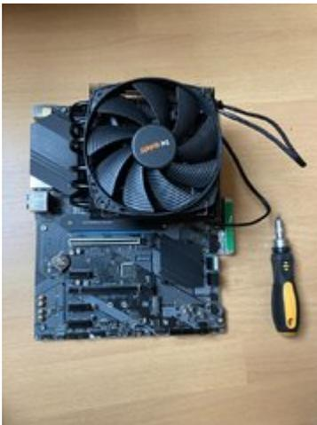
Jetzt sitzt das Mainboard auf dem Blech, durch die angeschraubten entfernten Anschraubpunkte gibt es keine Probleme das das Mainboard auf dem Blech aufsitzt und es einen Kurzschluss gibt.
