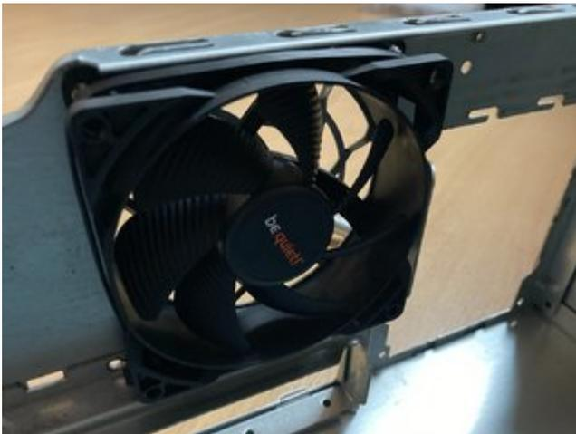
Jetzt wieder zum Mainboardblech, das lässt sich dann wieder ins Gehäuse legen und nach links in die Halterung des Bleches einrasten. Dann sitzt das Board wieder passend im Gehäuse.
