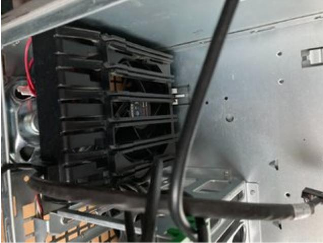
und eine hinten der die Warme Luft aus dem Gehäuse bringt.
