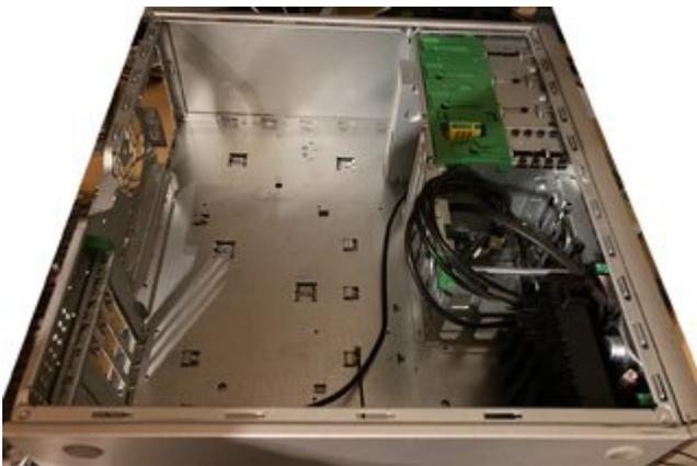
das Mainboard sitzt auf einer Metallplatte und die I/O-Blende ist direkt am Blech.
