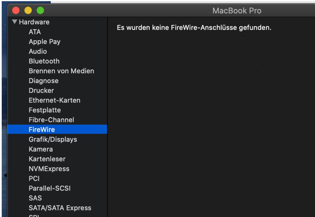
Da auch dein Audio-Interface angezeigt wird, funktioniert die FW-Karte und das FW-Kabel. Sonst könnte die SAFFIRE PRO 24 DSP ja auf dem Firewire-Bus nicht erkannt werden. Es scheint eher ein Problem mit der Saffire Mix Control Software unter Catalina oder mit der Stromversorgung vorzuliegen, aber ich kann nur feststellen, dass das Gerät generell auf dem FW-Bus angezeigt wird und die FW-Karte erkannt und eingebunden wird.
