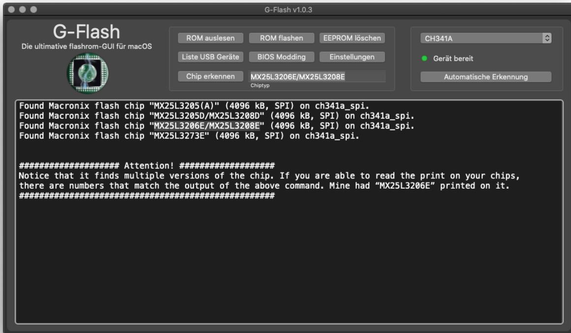
Auf dem Chip selbst steht bei mir auch "MX25L3206E", also habe ich "MX25L3206E/MX25L3208E" bei Chiptyp eingetragen und dann den ROM ausgelesen. Das funktioniert auch, aber am Ende, nachdem die .bin Datei auf dem Desktop liegt und "verifying flash" durchgelaufen ist, kommt ne Fehlermeldung:
