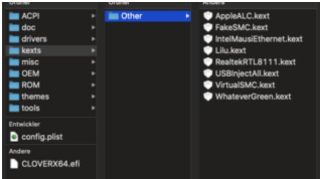
Der IntelMausiEthernet.kext ist vermutlich auch überflüssig, es wird offenbar der "RealtekRTL8111.kext" geladen.
