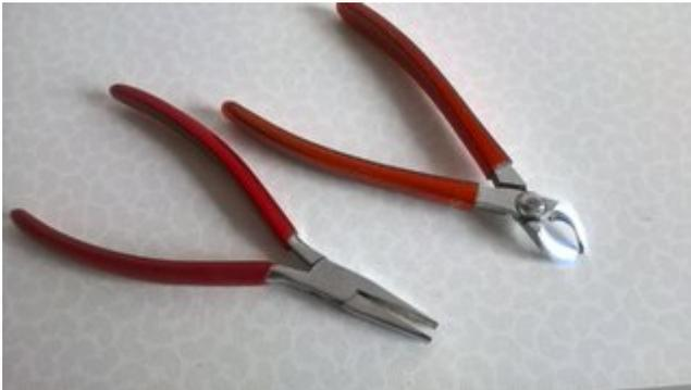
Sowas in der Art ist angebracht (hierfür aber eh nicht) - diese angeschrägte Schneidbackenform ist speziell für Platinen gedacht, so daß die Schneidfläche bei normaler Handhaltung parallel zur Platine steht - daneben eine ganz feine Flachzange.
