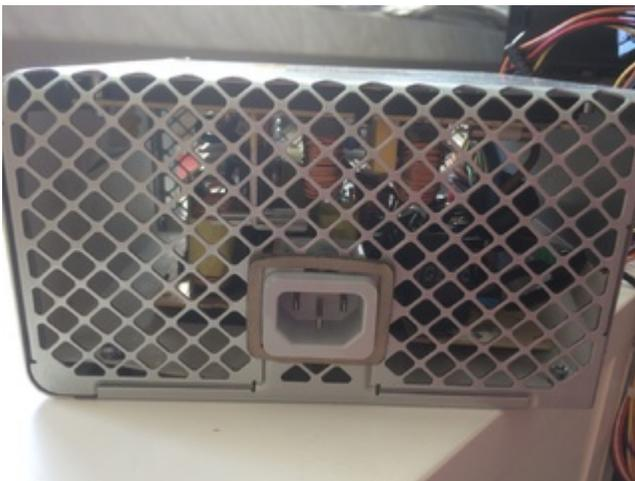
Und wie kommt der Strom dann letztlich "unten" an? Ich habe es [Arstidir](#) gleich getan und am Lüfterblech, welches aus Edelstahl besteht und Trennscheiben quasi frisst, gezielte Schnitte getätigt, so dass die Kabel den "Apple-way" nehmen, nur eben durch ein größeres Loch.
