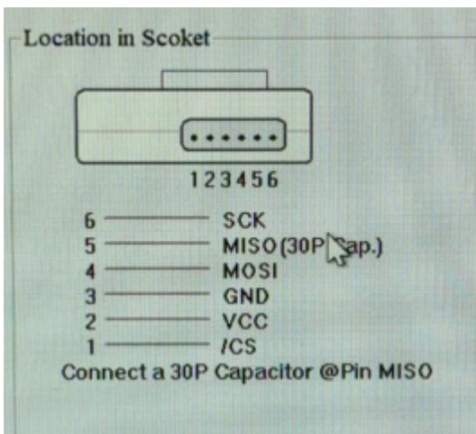
Ich bin danach gegangen, Verbindungen vom ISCP ausgehend zur Zange, also 1 auf 1; 2 auf 3, 7, 8; 3 auf 4; 4 auf 5; 5 auf 2 und 6 auf 6 ! Also hast du es korrekt verbunden. Den 30pf Kondensator kann man an der Platine für die Zange anlöten ...
