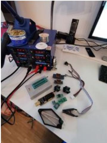
[locojens](#) ich habe mal bei dem TL866II Plus Programmer versucht den [Test-Clip](#) wie beim CH341A zu benutzen, aber keine Chance, der will nur ausgelötete Chips ohne alles, bei dir auch so?
