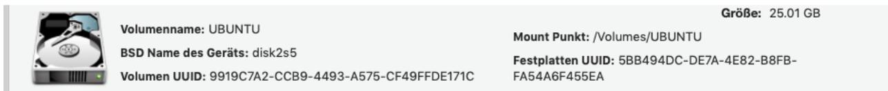
Man erkennt, daß in der grub.cfg die "Volumen-UUID" eingetragen ist - man kann das also aus macOS heraus reparieren.
