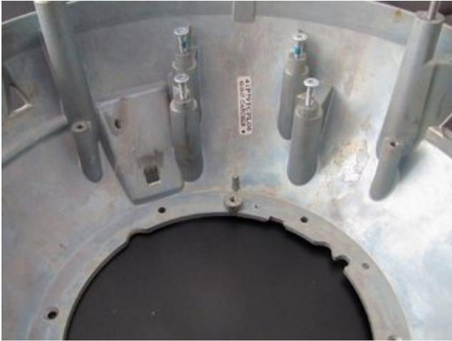
Der Gusskörper sorgte mit rund fünf Kilogramm nicht nur für das notwendige Gewicht der Basis – er nahm auch die Abwärme der CPU während eines langen Arbeitstages auf und gab sie in der Ruhepause langsam wieder ab. Für einen 24/7 Betrieb war die minimalistische Kühlung des iMac allerdings nicht ausgelegt – und daran hat sich auch heute nichts verändert.
