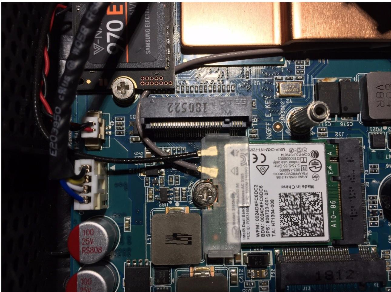
Der Einbau war recht kompliziert, aber aufschlussreich: alles Mögliche und Unmögliche ist über M.2-Kärtchen höhengestapelt an das Mainboard angeschlossen, von HDMI über Thunderbolt, Displayport, Sata, NvMe bis hin zum Bt/WLAN-Modul und musste abgezogen und -geschraubt werden. Komische Kiste!
