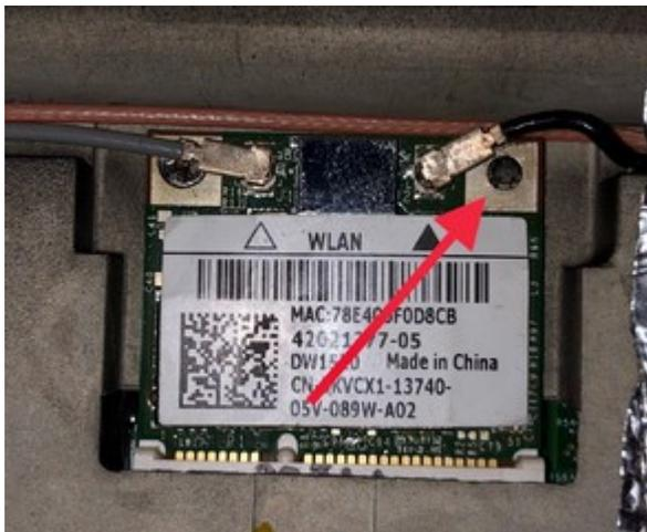
Original Intel WLAN Karte, die unter bspw. Windows 7 auch erkannt wird und damit richtig eingebaut sein müsste:
