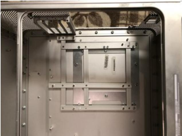
Dann habe ich noch den Rest der Anschlusslöcher von der Lüfterblende abgesägt, damit genug Platz für die ATX-Slotblende entsteht:
