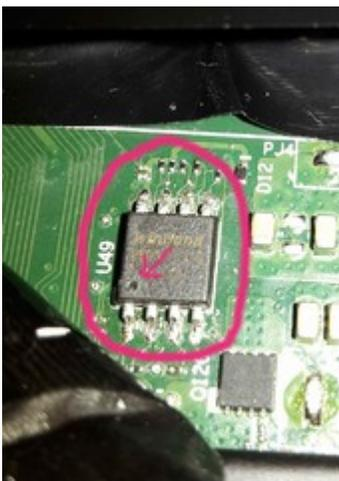
Auch gut zu sehen ist diese Vertiefung im Chip die mit einem Pfeil markiert ist. Da liegt PIN 1
