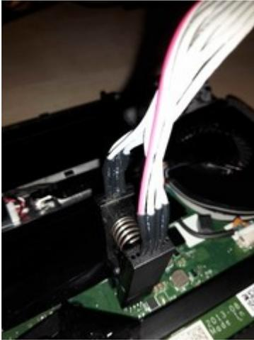
Die rote Ader befindet sich auf PIN 1. Somit ist der Rechner jetzt schonmal vorbereitet. Nun stecken wir die Zange an den Programmer:
