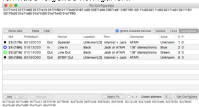
nur mit DSDT: Im HDEF-Bereich der DSDT muss die LayoutID 0B eingetragen werden!!!
