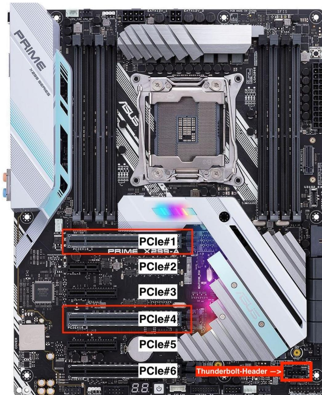
Steckplatz PCIe#1, PCIe#2, PCIe#3, PCIe#4, PCIe#5 oder PCIe#6?
