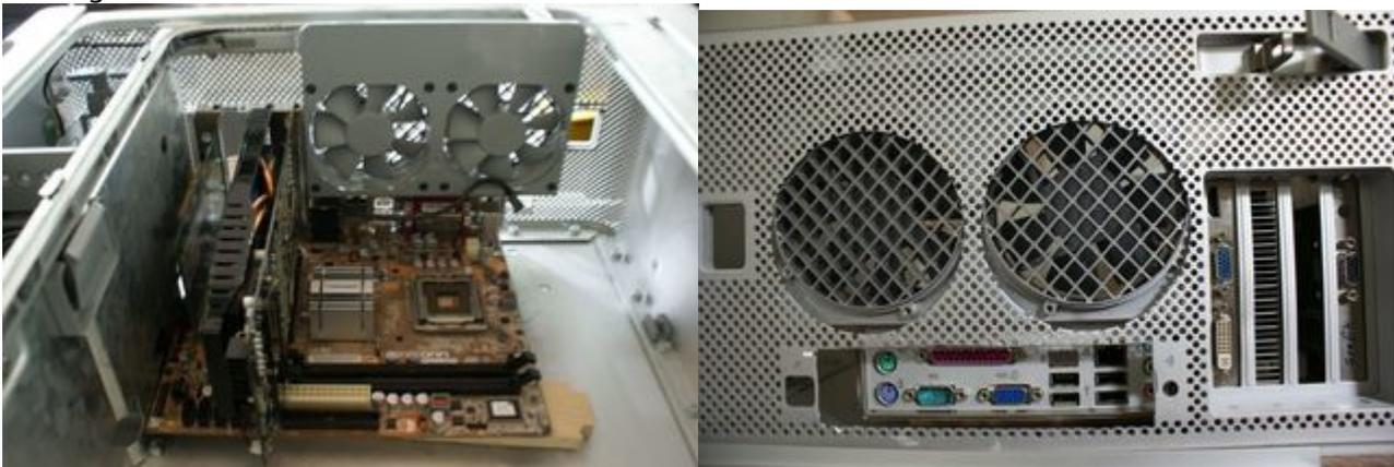
Mein defektes Foxconn-MB und die teildefekte HIS HD5770 mussten für die Passproben erhalten. Da der obere Bereich G5-typisch (DVD+ HDD-Korb) bleiben soll ((ebenso die untere Hälfte mit dem NT), kam nur ein mATX-MB in Frage - das wird wohl das Ga-Z87M-D3H werden.
