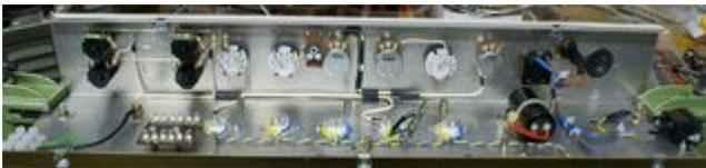
Auch die aufgefädelten Enden der abgeschirmten Leitungen (ws + gn) werden so ordentlich hergerichtet, ohne dass einzelne Äderchen/Folie des Abschirmmantels herausragen (so, wie Nio82 es auch beschrieben hat).
