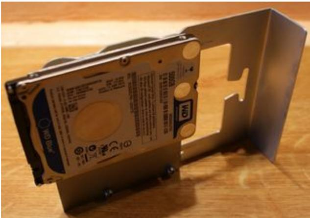
Aber selbst diese dünne Aluplatte versetzte die Fluchtlinien zum Anschlußblock so, dass der Rahmen samt 2.5-HDD/-SDD nicht so ohne Kraftaufwand nach hinten zu schieben war, sondern es musste leichter Druck auf die andere Ebenenachse ausgeübt werden, damit die Anschlüsse fluchteten. Elektrisch war nach Inbetriebnahme alles gut.
