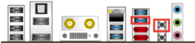
und schaltest den Rechner aus. Jetzt drückst Du 3 Sekunden lang den ebenfalls rot markierten Knopf auf der Rückseite des Rechners und der Flashvorgang startet nach den 3 Sekunden. Ein blinkendes Licht zeigt den aktiven Vorgang an. Der Flash ist beendet sobald das Licht aus bleibt.
