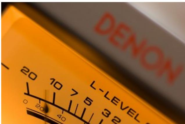
Die Pegelmesser des Tuners lassen sich auch zur Leistungsanzeige des Verstärkers nutzen; Dafür hat der Tuner auf der Rückseite Ein- und Ausgänge für ein Lautsprecherpaar. Ein Kopfhörerverstärker ist ebenfalls eingebaut.
