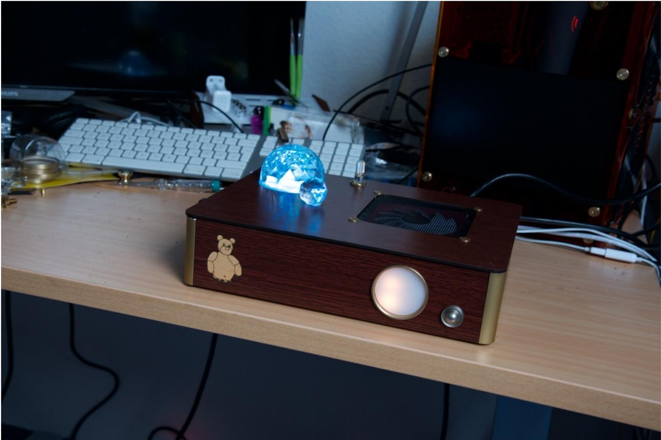
Hinter dem magischen Auge verstecken sich 4 RGB Leds. Im Moment sorgen sie für ein Licht, das in Abhängigkeit vom momentanen Prozessortakt verschieden schnell rotiert.
