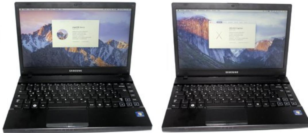
Was unter OSX funktioniert: Grafik-Ausgabe (512 MB) auch auf HDMI-Ausgang, Audio (Realtek), WLAN (mit Austauschkarte), Akkuanzeige, Backlight Control, Card Reader (USB), Kamera (USB).
