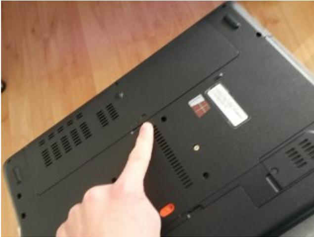
Bei mir ist eine Schraube verloren gegangen, weshalb ich nun weniger Arbeit beim öffnen habe 😄 darunter sind auf jeden Fall die Netzwerkkarte und die HDD. Ach und der RAM!
