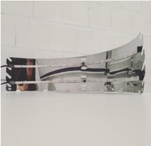
Diese "Lampe" ist eine Bastelei von mir - eine NZXT HUE+, die schlichtweg in einen Windschutz eines neuen Grills geklebt wurden. Mittels CAM Software (Windows) kann ich jede einzelne LED ansprechen und mit einer Farbe versehen. Sieht dann so aus 😊 (Der Strom wird nun nicht mehr via MOLEX aus dem PC, sondern von einem 5V Universalnetzteil gespeist, lediglich das ein USB Kabel muss noch an den PC gesteckt werden).
