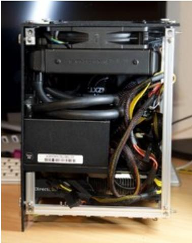
Von vorne sieht es noch voller aus. Im Wesentlichen weil die SSD und die Halterung für die Steuerelemente den Blick verdeckt. Bei der alten Version, waren Augen und Näherungsschalter an der Acrylglaswand angebracht, jetzt befinden sie sich an Haltern, die Teil des Rahmens sind. Hat Vor- und Nachteile.
