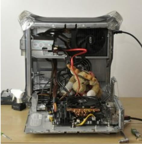
Im Innenleben geht das ja so weiter: den Lüfter mit Plastik-Pins befestigen? Hm! Hat mich im letzten Frühjahr ein Board gekostet! In den Trafo eine Schmelzsicherung einbauen kostet - deutlich weniger als ein Schaden ohne sie. Und so weiter.
